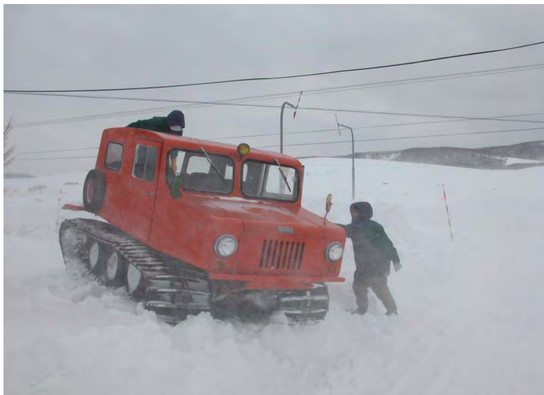
冬期の観測機器のデータ回収や点検には場所により雪上車を利用
